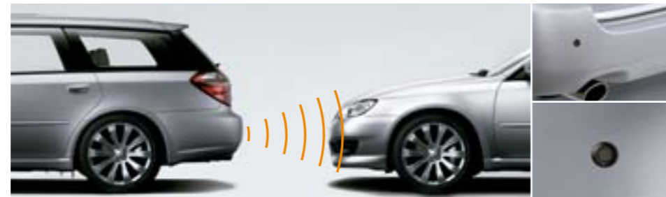
88 Ultraschall Einparkhilfe mit 2 Sensoren für vorne, 4 Sensoren für hinten SEWAYA2100, SEWAYA2002 ★ E Vorne: Erleichtert das Einparken wesentlich. Aktivierung über Parklichtschalter. Akustische Warnung. Hinten: Erleichtert das Einparken wesentlich. Aktivierung durch Einlegen des Rückwärtsgangs. Akustische und optische Warnung - LED-Anzeige
